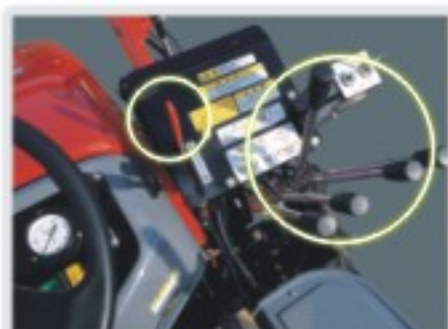
油壓式系統作動，可在噴霧同時，操作各式開關、傾斜、升降、伸縮。
